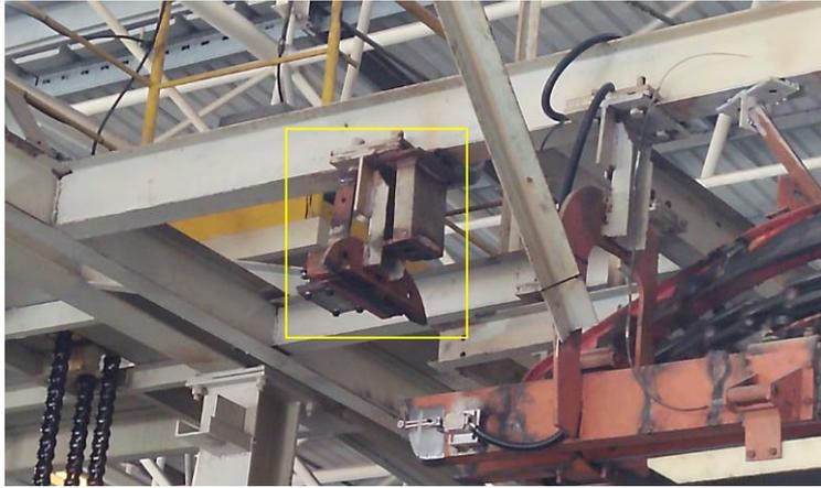
4.1.3 在升降机导轨支架前端两侧各焊接一个“7”字型 20mm 钢板（如图）。
